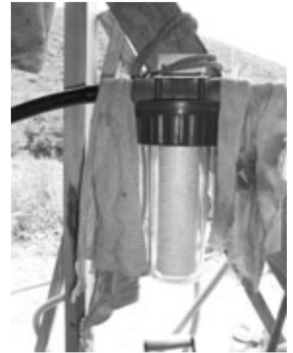
Foto: filtro de 5 micras usado en el proceso de filtraje del aceite reciclado
